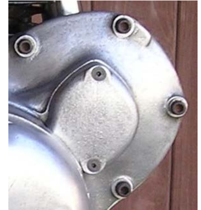
....dann Deckel neu ansenken, neue Senkkopfschrauben mit Innensechskant angebracht
