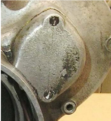
Vorher: Schlitzschrauben mit dünnem Gewinde, auch mit Schlagschrauber nicht zu lösen.....
