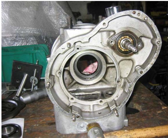
Motorgehäuse - Nockenwelle und Lager in sehr gutem Zustand, daher dort kein Lagerwechsel erforderlich
